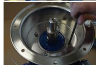
Obr. 3.3.9. Sejměte šrouby [121] a podložky [122] držící zadní kryt [11] k motoru [10].
