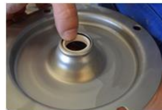
Obr. 3.3.7. Pokud je to nutné, vytlačte statickou část [15B] mechanické ucpávky. POZNÁMKA! Před vysunutím mechanické ucpávky naneste trochu lihu nebo vody..
