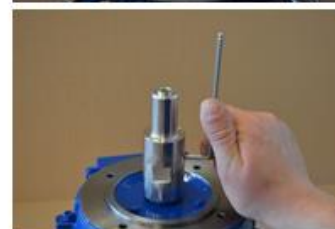
Obr. 3.3.10 Povolte pojistné šrouby [161] a sejměte nástavec hřídele [16].
